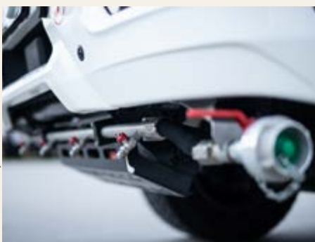
Sprühdüse mit zusätzlichem Anschluss für einen Schlauch.
